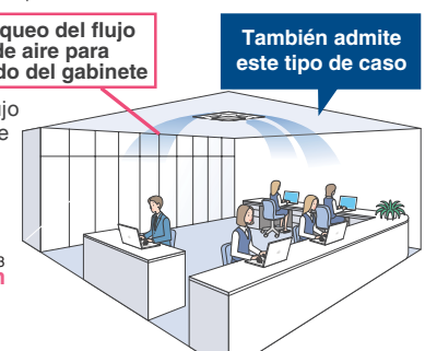
La función de bloqueo de flujo de aire previene las corrientes molestas al reducir la velocidad del aire en aprox. 0.3 m/s. 2
